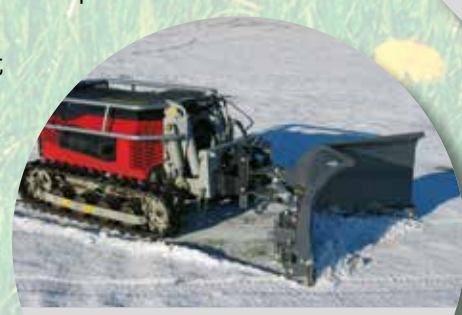
Le réglage Y est utilisé lorsque la neige doit être dégagée des trottoirs, chemins et routes, rassemblant la neige en un seul endroit.
