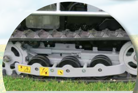
Les rouleaux de support dans les chenilles sont faits de métal additionnés de roulements graissés, offrant une plus longue durabilité.
