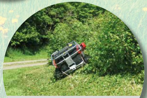
La débroussailleuse à fléaux écrase la matière en une couche uniforme avec une belle finition.
