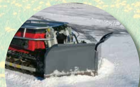
Le réglage V est utilisé pour traverser de grandes quantités de neige, la neige est alors poussée des deux côtés.
