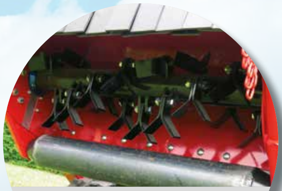
Le RC-751 est équipé de série de fléaux Y tout autour du rotor.
